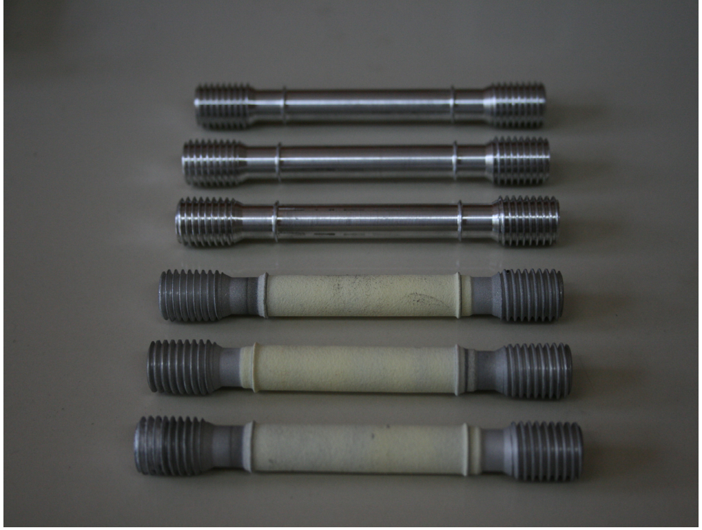
Şekil 3.20: Sürünme deneylerinde kullanılmak üzere hazırlanmış kaplanmamış ve Y-PSZ ile kaplanmış 6063 alüminyum numuneler.
