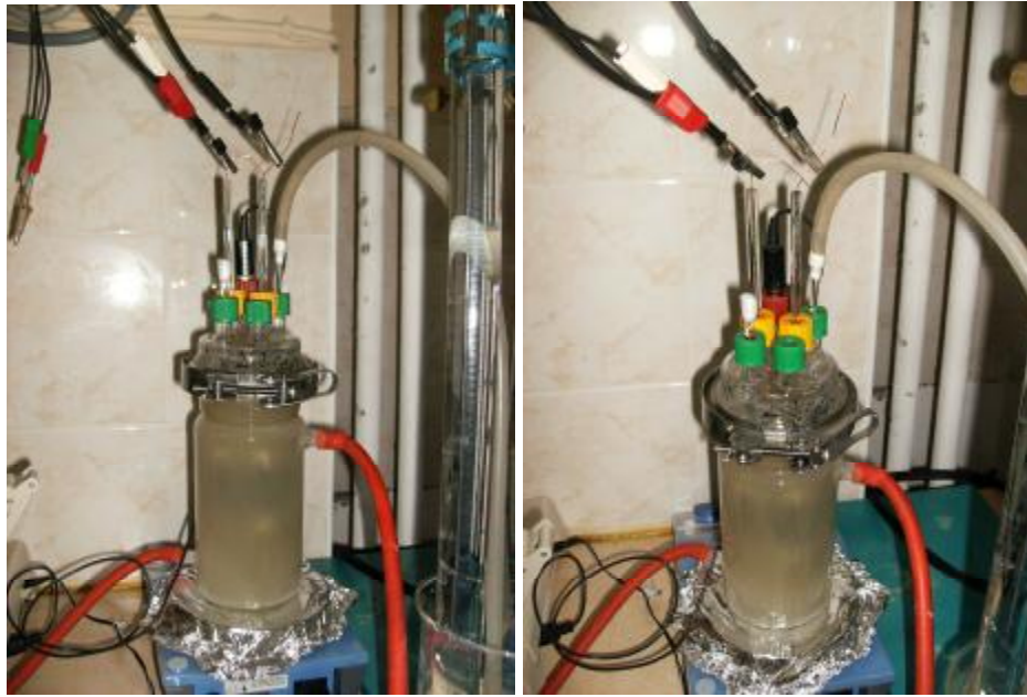
Şekil 3.1. Tek odalı ve membransız mikrobiyal elektroliz hücresi
