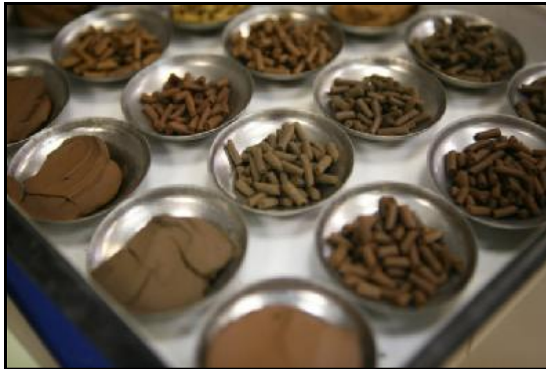
Şekil 3.7. Plastik limite ulaşmış numune örnekleri ( http://www.isotop.co.il )
