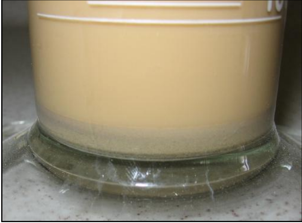
Şekil 3.10. 24 saat sonunda mezür tabanında çökelen tanelerin görünümü
