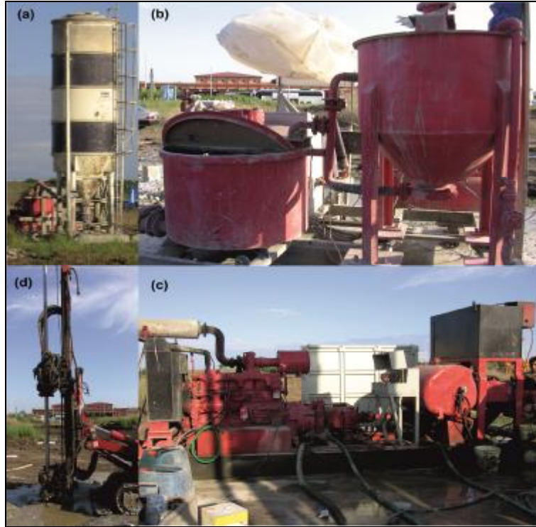
Şekil 4.8. Jet grout sistemine ait teknik ekipman
