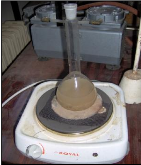
Şekil 3.8. Kaynatma yöntemi ile piknometre deneyi
