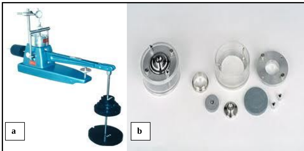
Şekil 3.16. a) Konsolidasyon cihazı, b) Konsolidasyon hücresi (www.impact-test.co.uk)
