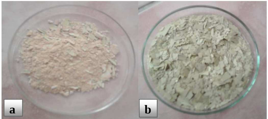
Şekil 3.1 Dekantasyon sonucu: a. çöken safsızlıklar, b. elde edilen saf Na-MMT
