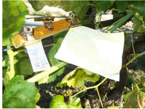
Şekil 3.20. Arazi çalışmasında filtre kağıdı ve suya duyarlı kağıdın bitki içinde kısıkaçlarla tutturulmuş görüntüsü.
