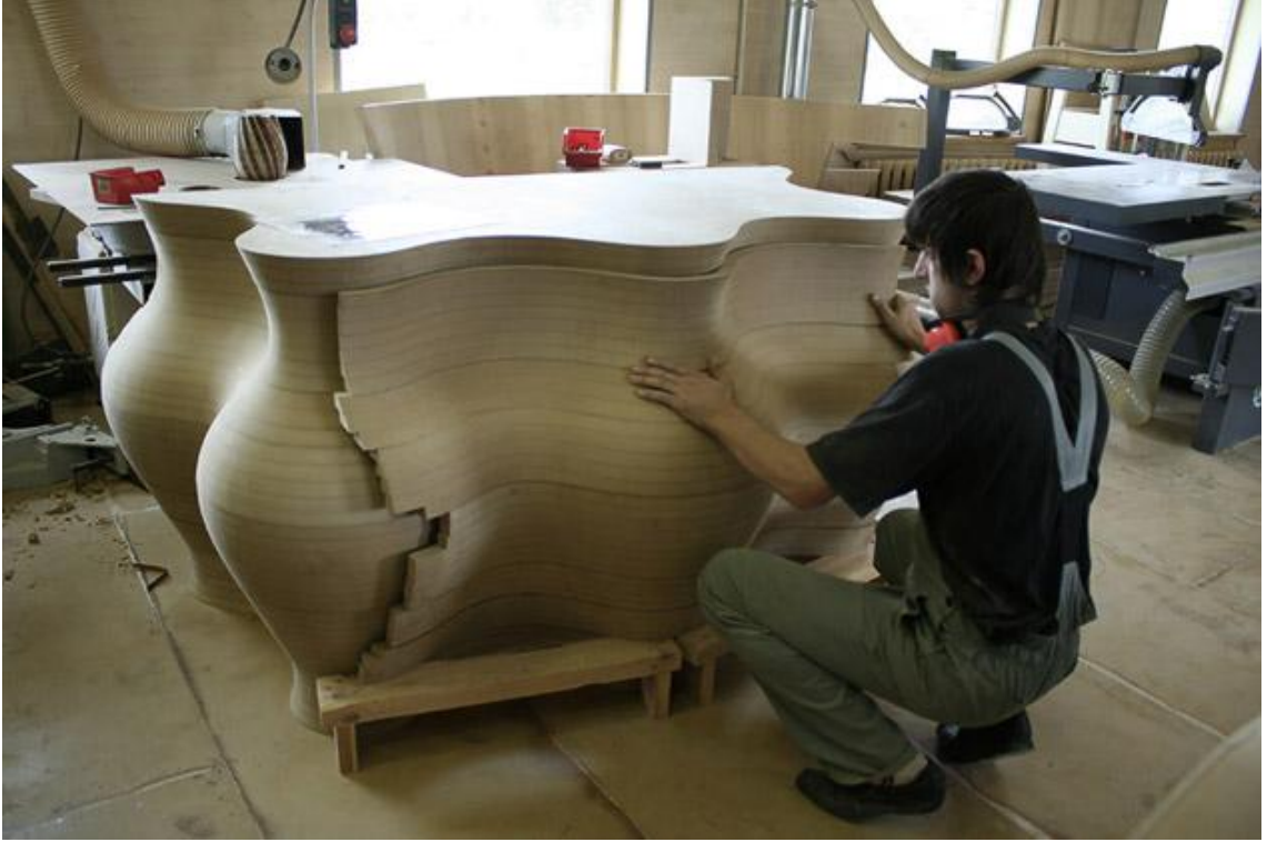
Resim 4.13 Vase Cabinet'in CNC sonrası birleştirilme süreci ( http://www.contemporist.com/2009/06/21/the-making-of-the-4-vase-cabinet-by-katz/ )
