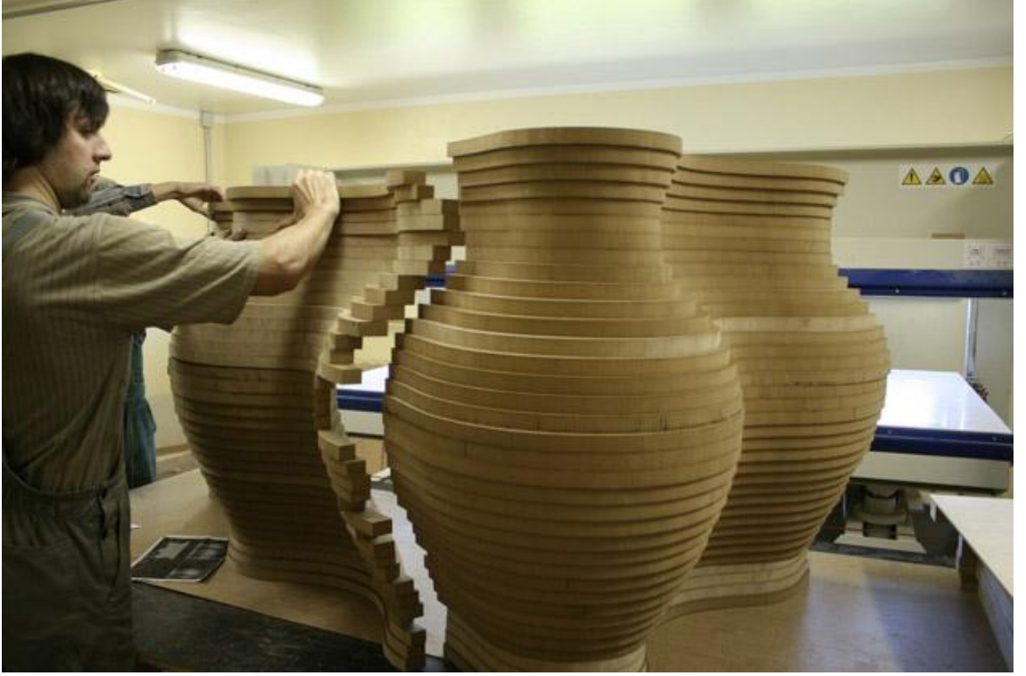
Resim 4. 12 Vase Cabinet'in CNC sonrası birleştirilme süreci ( http://www.contemporist.com/2009/06/21/the-making-of-the-4-vase-cabinet-by-katz/ )
