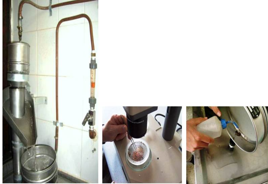
Şekil 3.2. Toprak örneklerinden kistlerin elde edilmesinde kullanılan Kort cihazı
