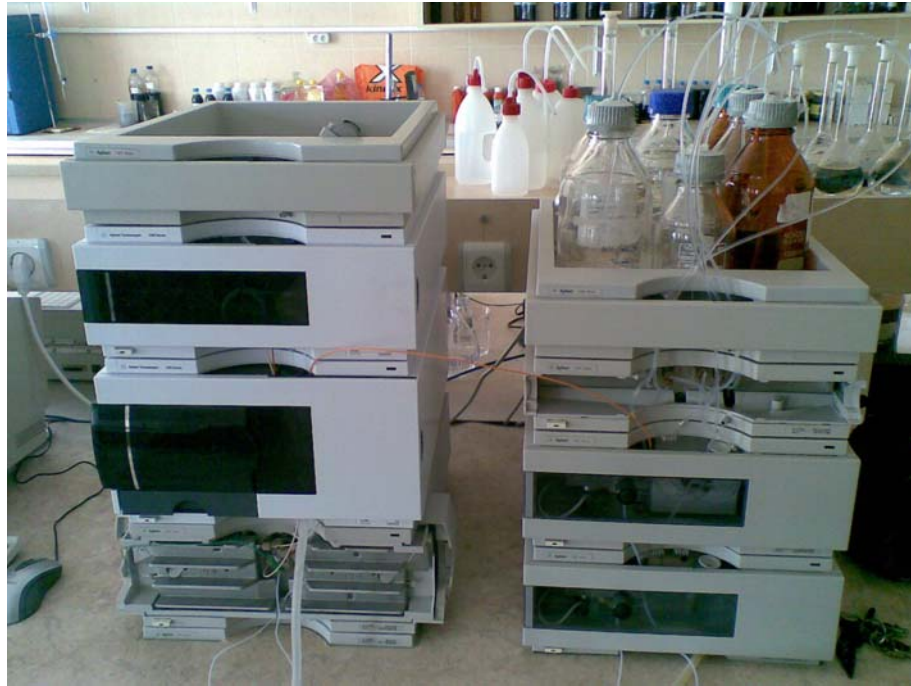
Şekil 6. 1. Akış enjeksiyon analizlerinde kullanılan HPLC sistemi
