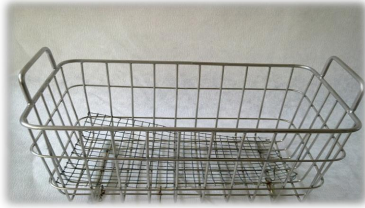
Şekil 3.2 Ozmotik kurutma işlemi sırasında örneklerin koyulduğu metal kafes
