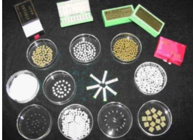
Şekil 2.7. Değişik şekil ve biçimlerde termolüminesans dozimetreler (VIII).
