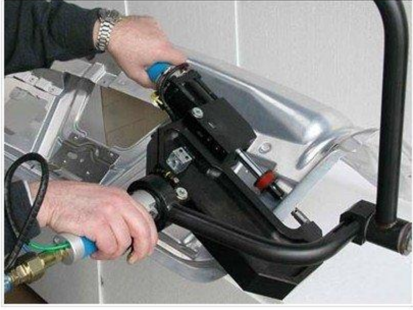
Şekil 2.46 Form punta el makinesi (İnt.Kyn.10).
