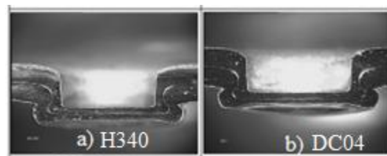
Şekil 2.10 Farklı malzemelerin yaptığı bağlantıların kesit görünüşü (Tan et al. 2005).
