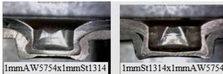
Şekil 4.19 Farklı malzemelerle yapılan bağlantıların kesit görünüşleri
