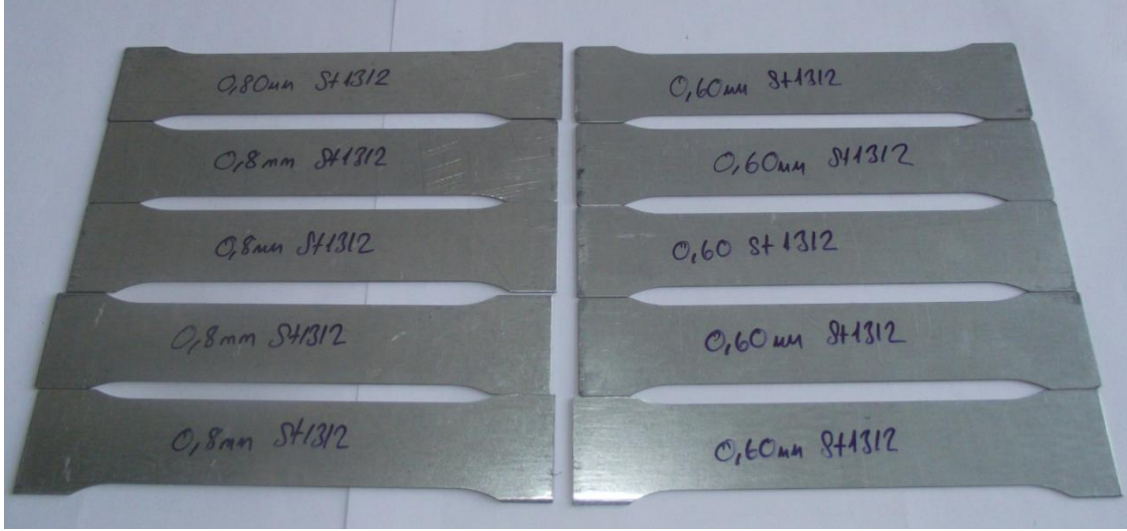
Şekil 3.12 TS EN ISO 6892-1 standardına uygun çekme deneyi için hazırlanan numuneler.
