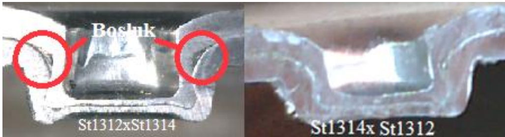
Şekil 4.4 Farklı malzemelerin bağlantı kesitleri
