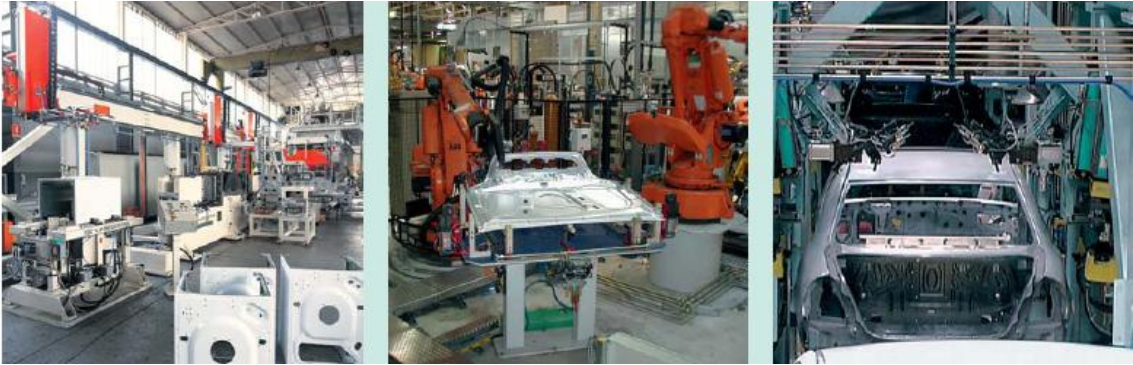
Şekil 2.47 Robot kollarına bağlanmış otomatik Form punta uygulama örnekleri (İnt.Kyn.10).
