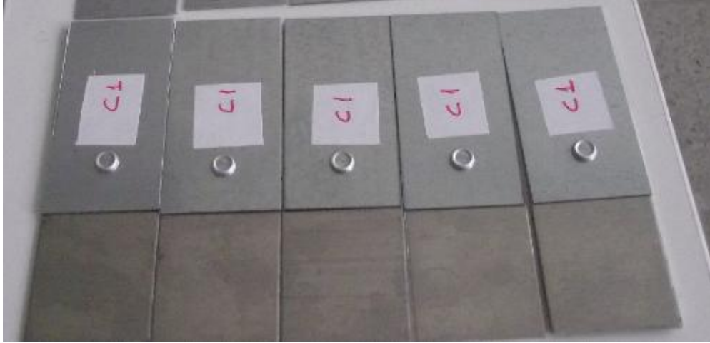
Şekil 3.10 TSE EN ISO 14270 Standardına uygun birleştirilen malzemeler.
