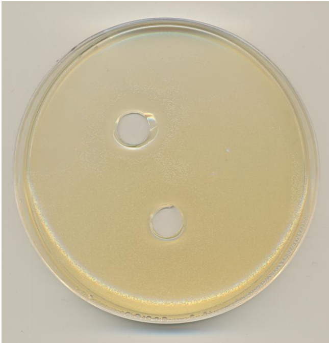
Resim 4.5. Lactobacillus plantarum DSM 20246 suşunun E. coli ATCC 35218 suşu üzerinde gösterdiği inhibisyon zonu.
