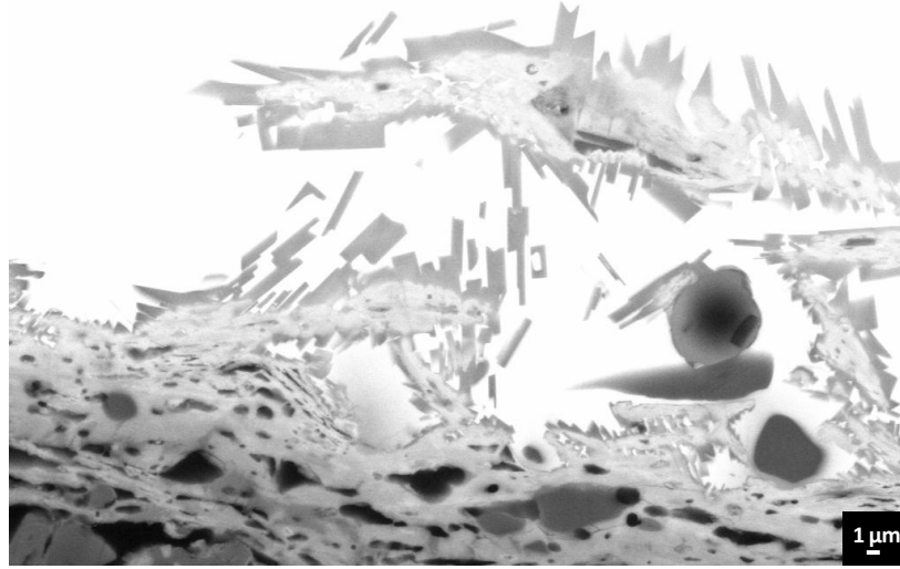
Şekil 4.65. K50 kodlu numunenin sır- bünye kesitinde oluşmuş kristallere ait SEM-BSE görüntüsü
