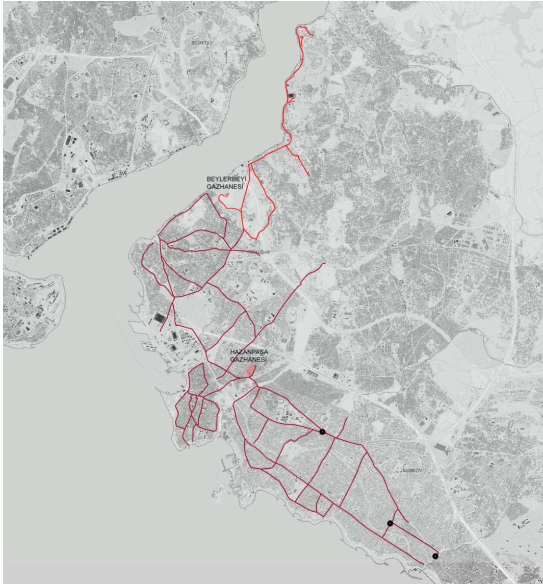
Şekil 4. 18: Hasanpaşa Gazhanesi 1940 yılında Beylerbeyi Gazhanesi'nin üretimine son verilmesiyle birlikte, Beylerbeyi şebeke hattı ile bağlanarak çalıştırılmış, kapatıldığı 1993 yılına kadar geçen süreçte şebeke son halini almıştır. Beylerbeyi Gazhanesi döneminde yapılan şebeke ana boru hatları turuncu ile gösterilmiştir. (Arzu Yoldemir)
