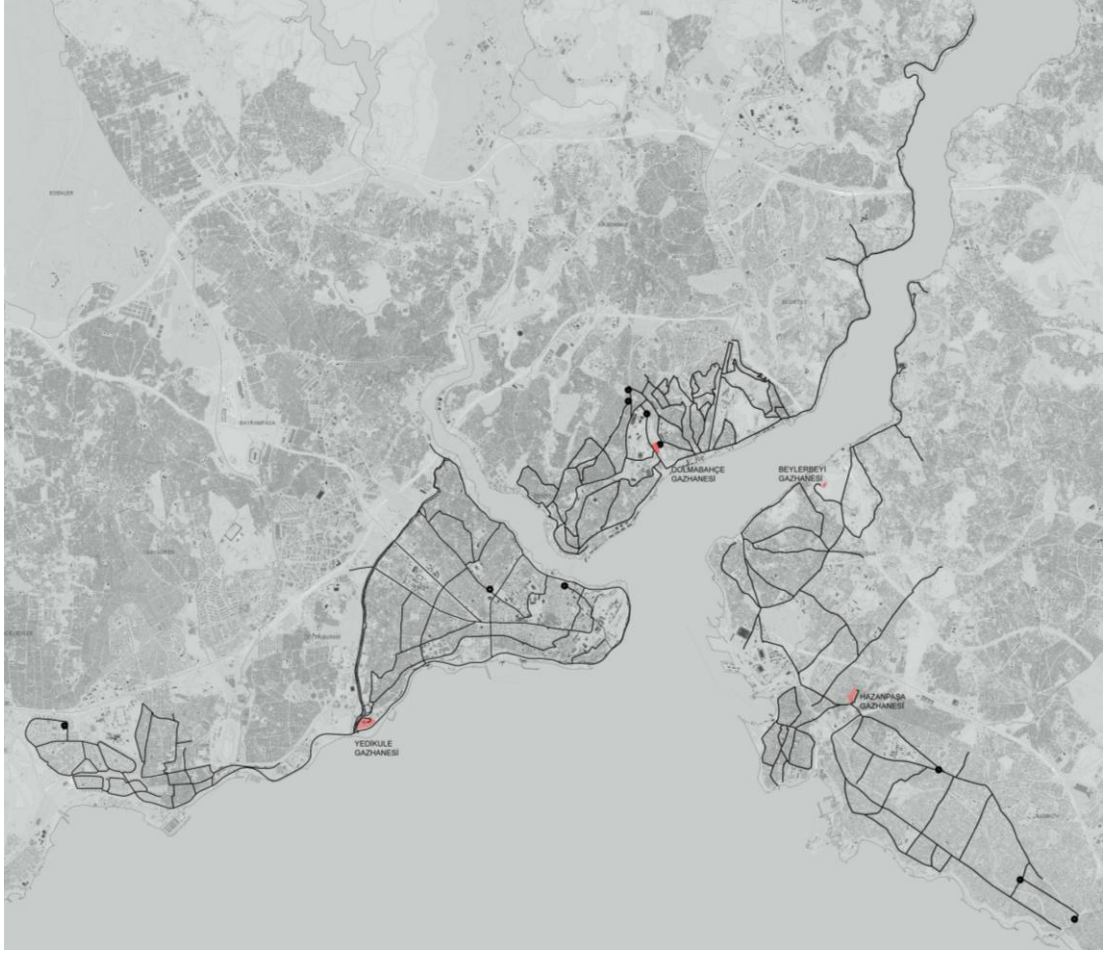
Şekil 6. 4: 1892 yılında kurulan Hasanpaşa Gazhanesi'nin 1993 yılında üretimine son verildiği güne kadar döşenen havagazı şebekesi ana boru hatları ve bu dönemde kente yayıldığı bölgeler görülmektedir. (Arzu Yoldemir)
