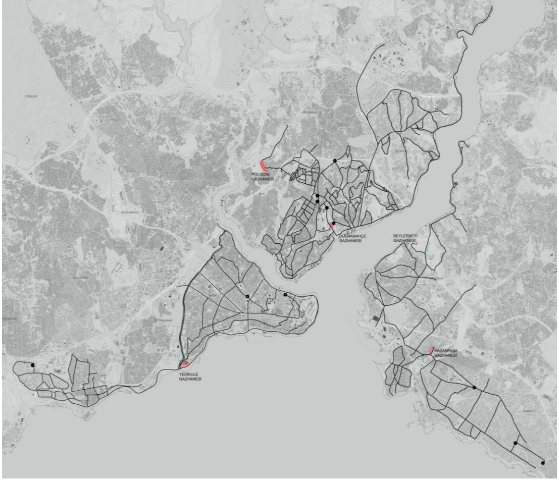
Şekil 6. 5: 1957 yılında kurulan Poligon Gazhanesi'nin 1993 yılında üretimine son verildiği güne kadar döşenen havagazı şebekesi ana boru hatları ve bu dönemde kente yayıldığı bölgeler görülmektedir.
