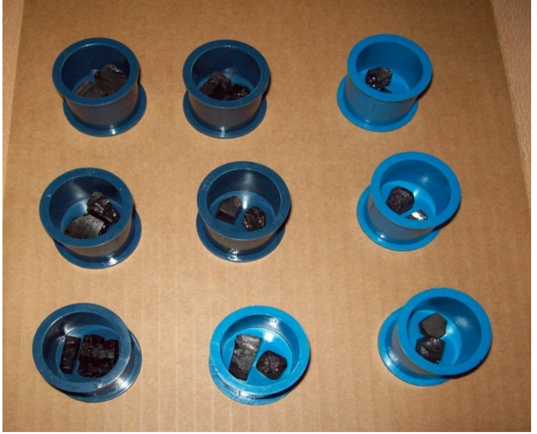
Şekil 3.2: Epoksi dökülmüş kalıplar
