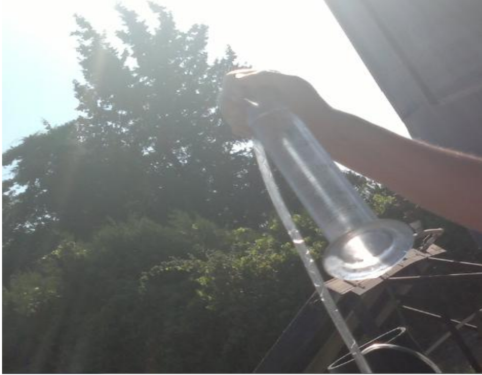
Şekil 3.5. Yoğunlukları ölçülen tabakaların yükseklik farkı kullanılarak aynı tabakaya aktarılması
