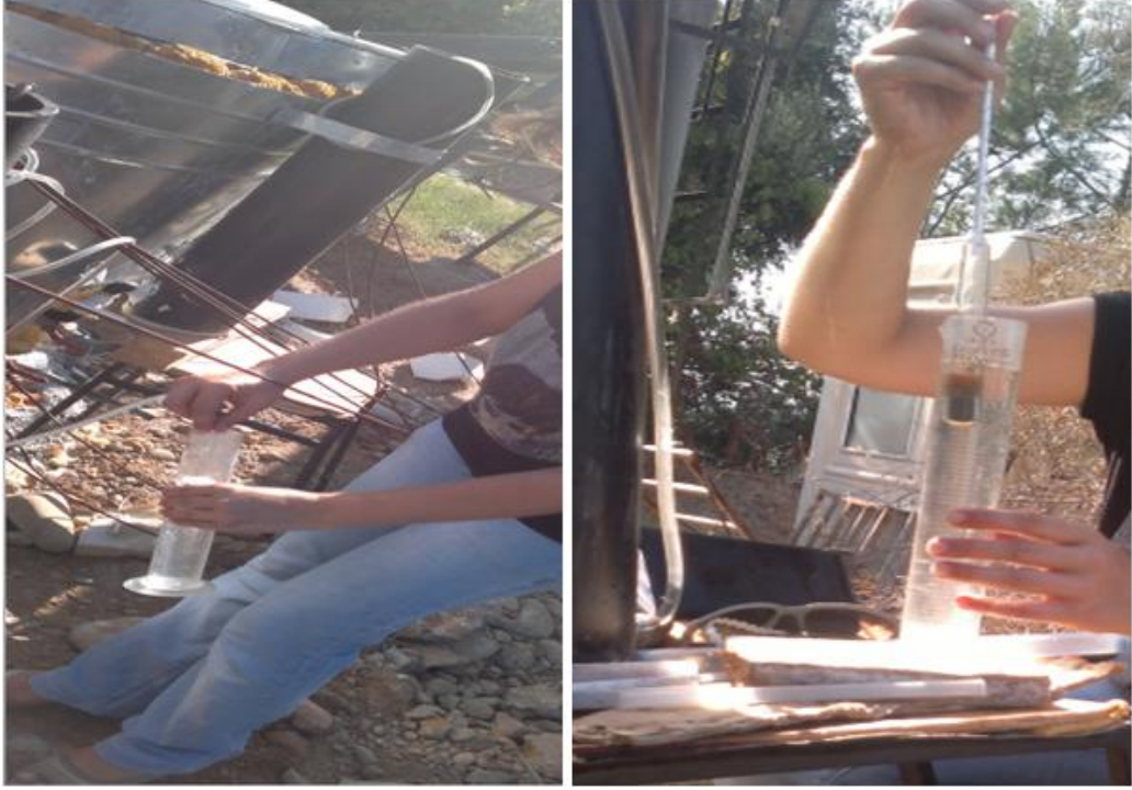
Şekil 3.4. Tuzlu su numunelerinin havuzdan alımı ve ölçülmesi
