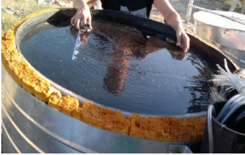
Şekil 3.6. Buharlaşma bölgesinin tabaka seviyesini sabit tutma
