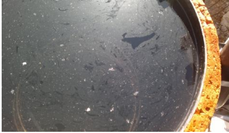
Şekil 4.3. Buharlaştırma bölgesinin üst yüzeyindeki kirlilik
