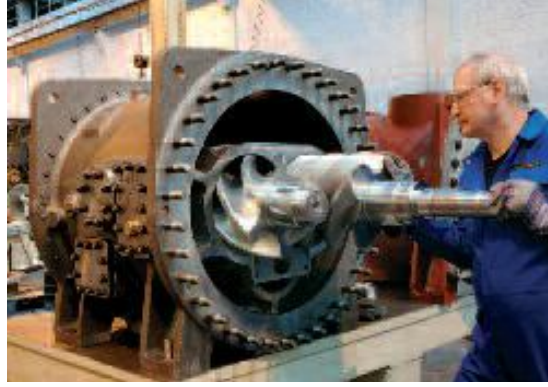
Şekil 3.1.19 Çift vidalı kompresörün montaj görünümü
