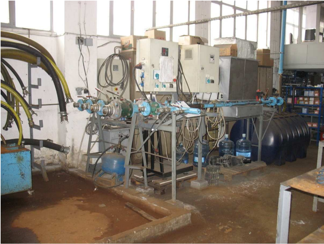
Şekil 4.3 Deney sistemi basma hattı
