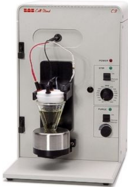
Resim 3.3. Katı elektrot hücre standı
