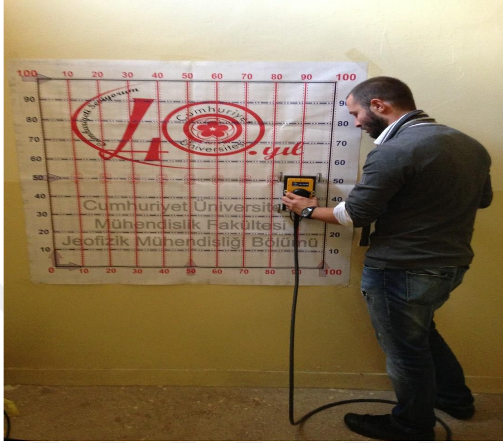
Şekil 3.5 Mühendislik Fakültesi B binası Perde duvar üzerinde ölçü alımı gösterimi.
