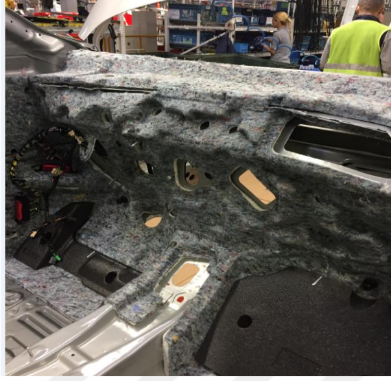
Şekil 4.10 : Ön göğüs ses izolasyonu uygulama örneği
