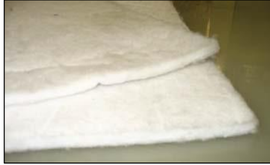
Şekil 4.11 : PET mikrofiber akustik malzeme örneği
