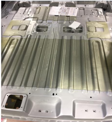
Şekil 4.16 : Araç gövdesi üzerindeki titreşim sönümleme elemanları
