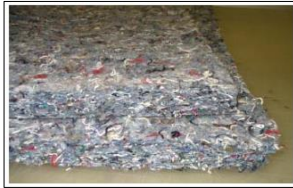
Şekil 4.9 : Koton keçe akustik malzeme örneği
