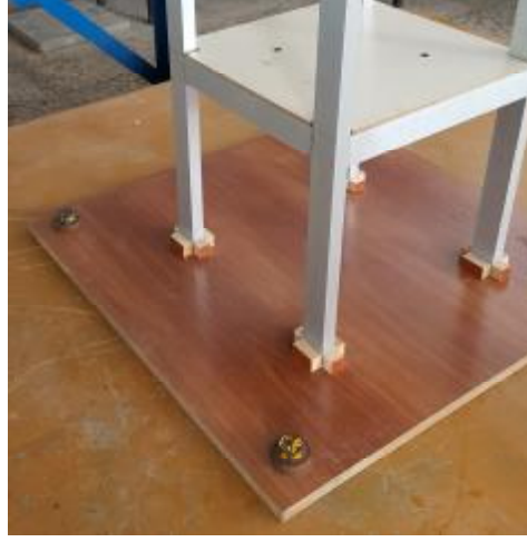
Şekil 3.29. Kolon mesnet noktası detayı ve model-tabla bağlantısı
