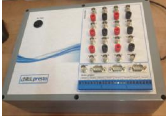
Şekil 3.4. CUSHAKE sarsma tablası veri toplama sistemi
