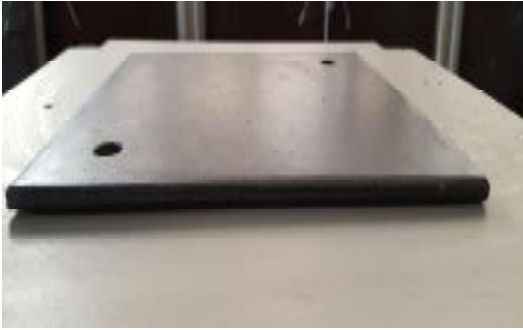
Şekil 3.30. Çok serbestlik dereceli modellere yerleştirilen kütleler
