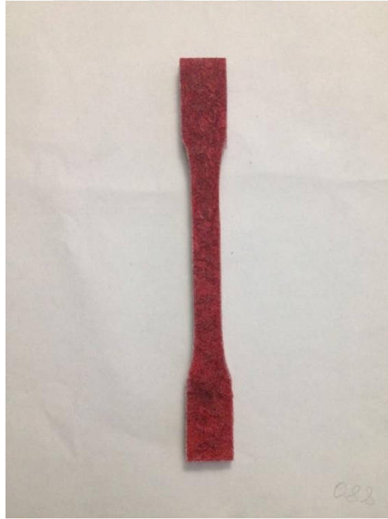
Şekil 2.7 : Tesviye edilerek standart boyutlara getirilmiş bir numune.
