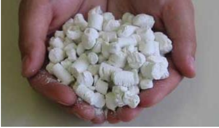
Şekil 3.2. İşlem görmüş (makarna haline getirilmiş ) kaolen numunesi
