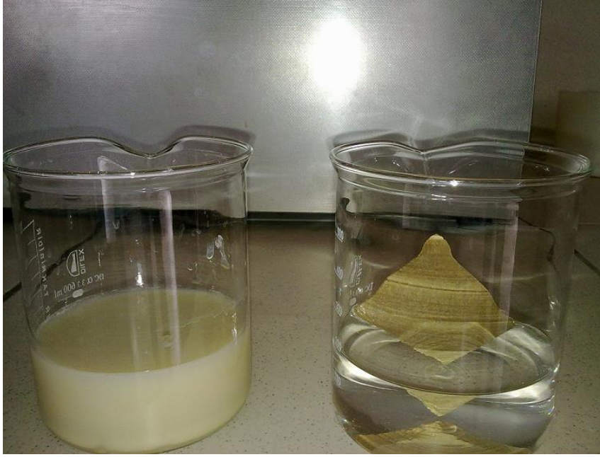
Şekil 4.75. 1 hafta suda bekletilmiş numuneler Ham seramik karo (sol) – Jeopolimer karo (sağ)
