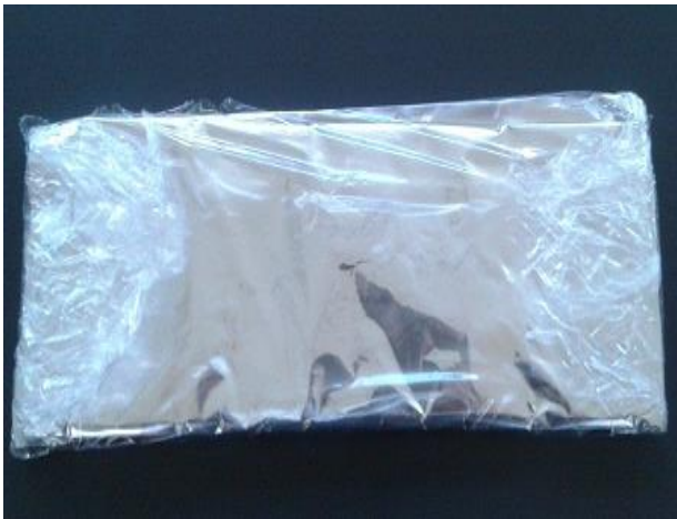
Şekil 3.20. K rleme mekanizması i in karoların folyo ve stre  ile sarılması
