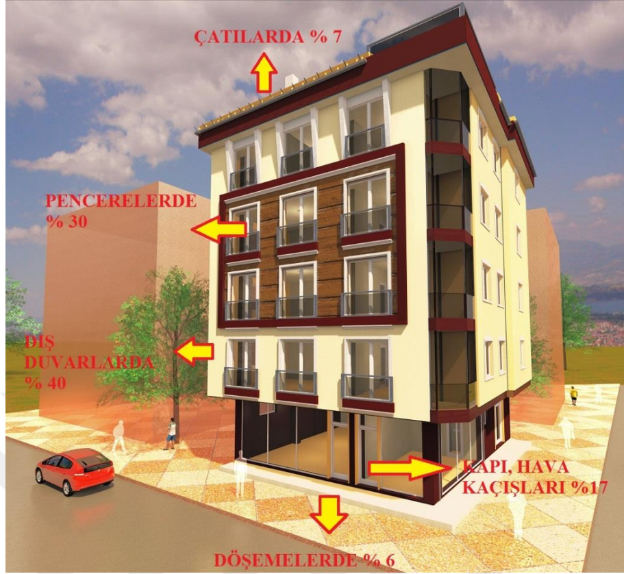
Şekil 3.3. Çok katlı binalarda yapı elemanlarından ısı kayıpları
