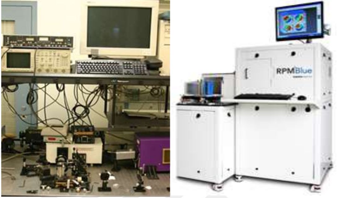
Şekil 3.49 Çalışmalar kapsamında fotolüminesans ölçümleri için kullanılan Northwestern Üniversitesi Center for Quantum Devices laboratuvarlarındaki Argon iyon lazere sahip oda sıcaklığı fotolüminesans ölçüm sistemi (sol) Ermaksan Optoelektronik laboratuvarlarında kurulu bulunan Nanometrics-RPM Blue marka model fotolüminesans ölçüm sistemi (sağ).
