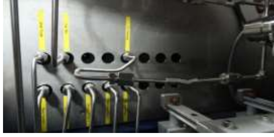
Şekil 3.13 Reaktör haznesine giden hatlar (Run MO, Run Hyd, Lineer Purge 1, lightpipe, Window 1,2,3 ve Main rotation).
