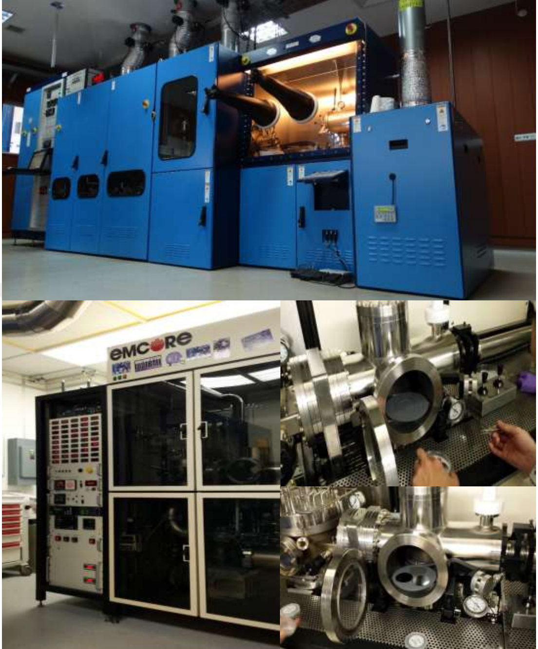
Şekil 4.7 Cumhuriyet Üniversitesi Nanofotonik Uygulama ve Araştırma Merkezi'nde kurulu bulunan Aixtron marka AIX 200/4 RF-S model yatay akışlı MOCVD reaktörü (üst) ve TÜBİTAK 2214/A Yurtdışı doktora sırası araştırma bursu kapsamında 1 yıl çalışmalarda bulunulan Northwestern Üniversitesi Center for Quantum Devices laboratuvarlarında kurulu Emcore marka dikey akışlı MOCVD reaktörü (alt).
