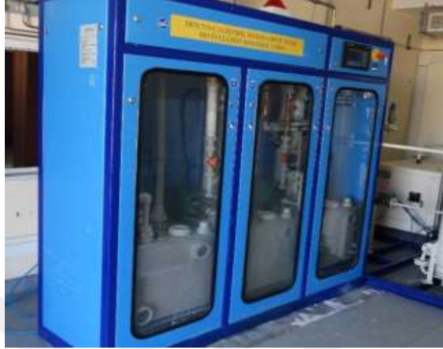
Şekil 3.34 MOCVD reaktöründe büyütme sırasında kullanılan ve büyütme sonrasında ortaya çıkan zehirli atık gazların tehlikesiz hale getirilmesi için çeşitli kimyasal çözeltiler içeren 3 aşamalı atık temizleme ünitesi.
