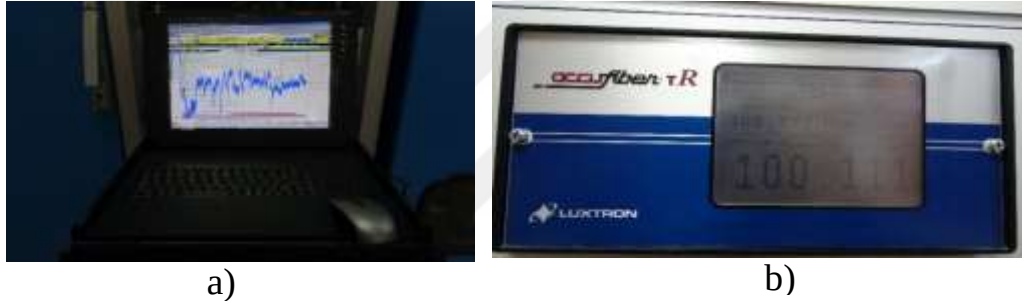
Şekil 3.4 MOCVD sistemine ait ana bilgisayar (a) ve büyütme için yerinde yansıma ve sıcaklık ölçümü yapan LUXTRON sistemi (b).
