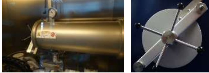
Şekil 3.25 Eldivenli kutu içerisinde bulunan ön odacık (antechamber) ve reaktör içerisine kuars malzeme, alttaş vb parçalar koyabilmek için dış ortama açılan kapak.
