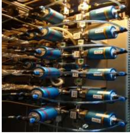
Şekil 3.12 Run ve vent hatları arasındaki geçişi sağlayan 5/2 valfinin görünümü.
