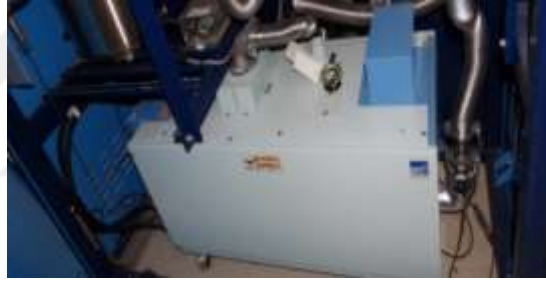
Şekil 3.33 MOCVD reaktöründe değişken basınç ortamlarında büyütme yapabilmek için kullanılan EBARA A25 S ana pompa.
