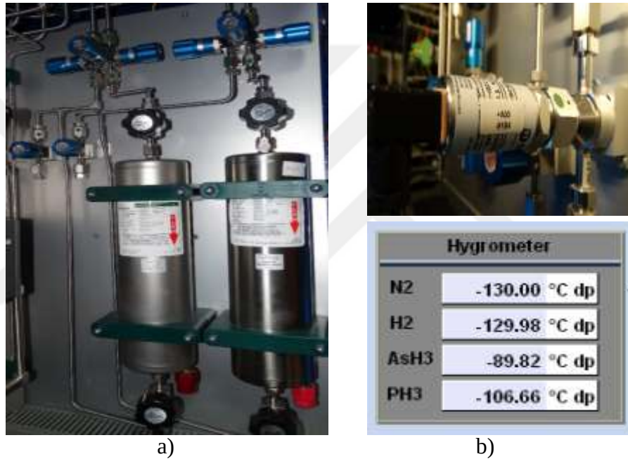
Şekil 3.17 MOCVD sisteminde kullanılan hidrojen ve azot gazlarının daha yüksek seviyede temiz hale getirilmesi için kullanılan saflaştırıcılar (a), kullanılan gazların çiğ noktası ölçer cihaz ve ölçüm değerleri (b).
