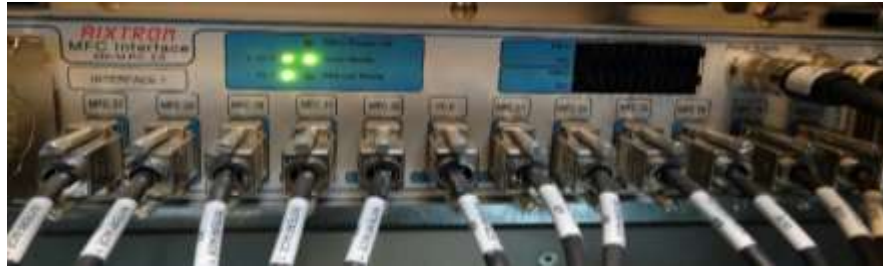
Şekil 3.16 Kütle akış kontrolörü ve basınç kontrolörlerin bilgisayar ile kontrolü için kullanılan arayüz (interface).
