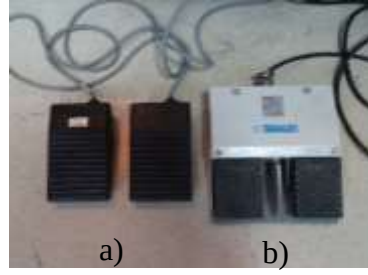
Şekil 3.27 Cımbızla alttaş arasında vakum oluşturmak için kullanılan pedallar (a) ve eldivenli kutu içindeki basıncı gerekli durumlarda manuel olarak arttırmak ya da azaltmak için kullanılan pedal grubu (b).
