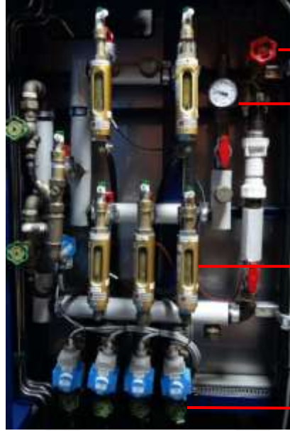
Şekil 3.23 MOCVD sisteminde kullanılan soğutma suyuna ait dağıtım ünitesi.
