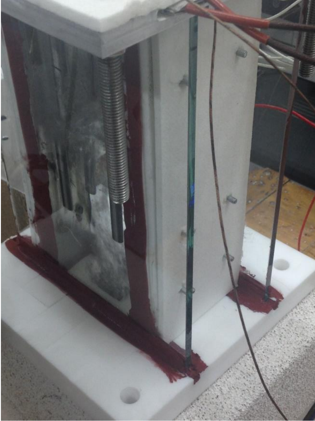
Şekil 3.6: Isı geirgenliğini azaltmak için kullanılan cam yünü.
