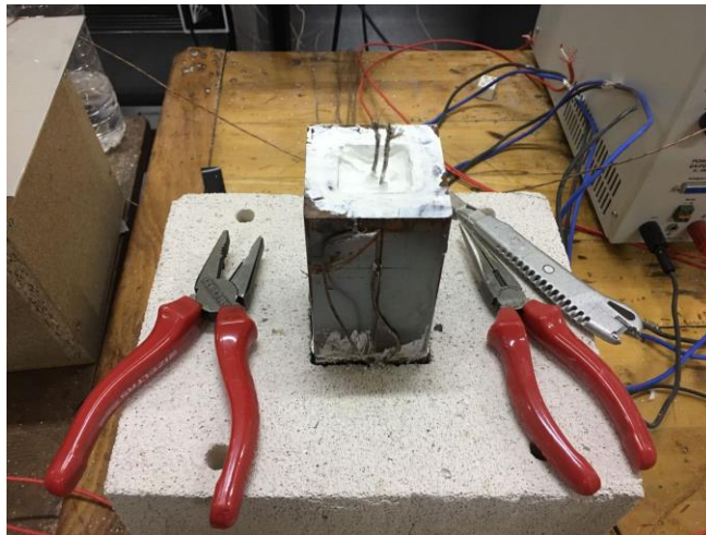
Şekil 3.5: Termal macun sürülmüş yüzey altı termo elemanları.
