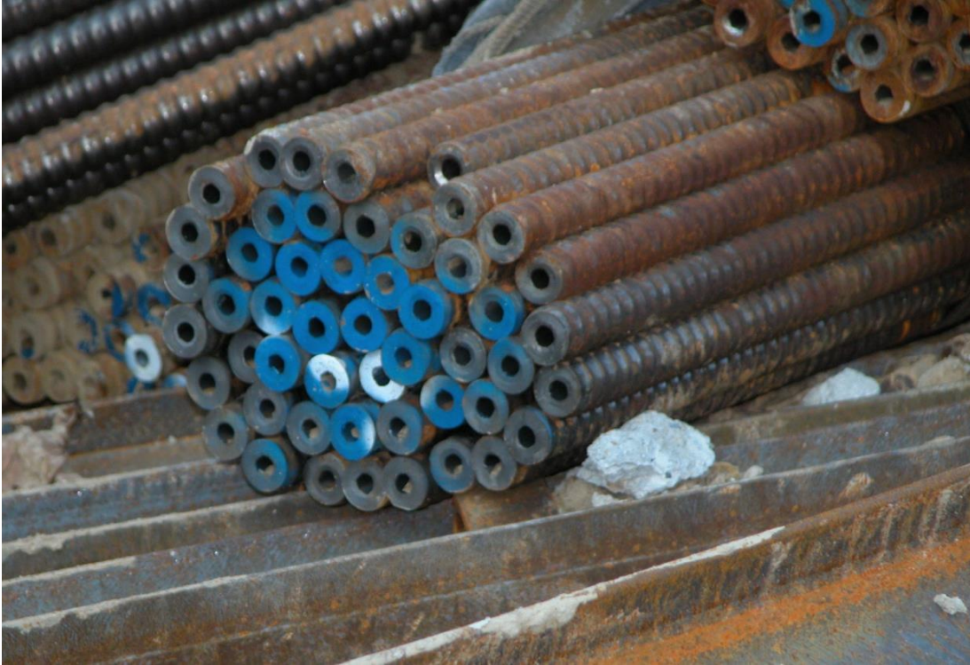
Şekil 4.3 : Kaya bulonlamada kullanılan içi boş nervürlü demir çubuklar.
