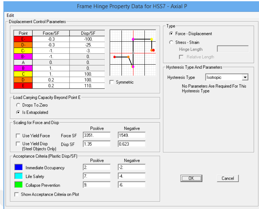
Şekil 4.16: SAP2000’de kullanılan MÇÇÇ burkulmalı plastik mafsal modeli.
