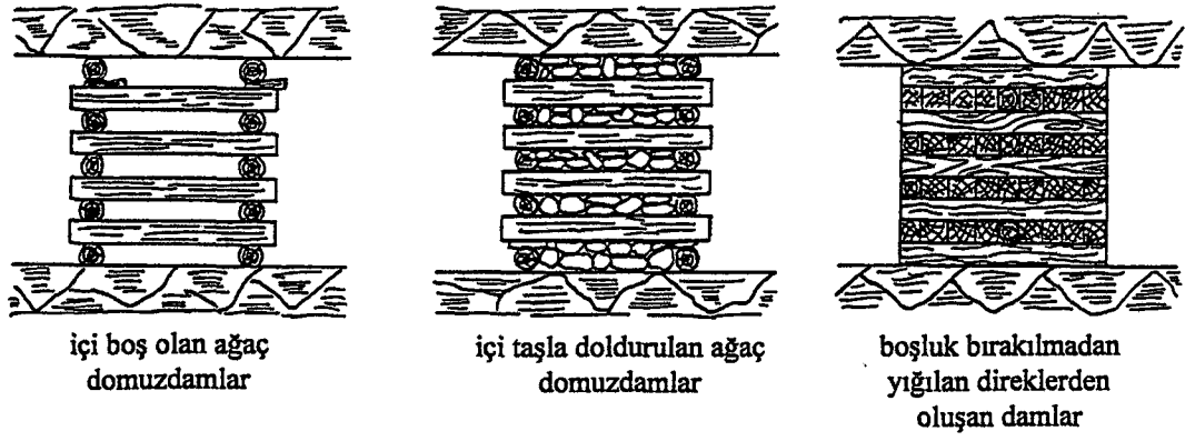
Şekil 3.39. Tabanyolu kenar takviyesi olarak çeşitli ağaç domuzdamı uygulamaları (WBK, 1985).
