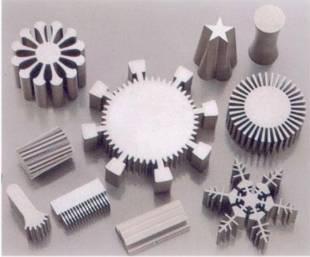
Şekil 2.13. EDM yöntemiyle şekillendirilmiş parçalar
