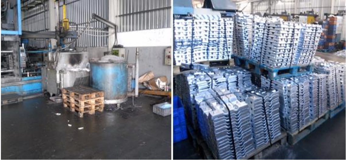
Şekil 4.4. Alüminyum zamak ve ergitme ocağı
