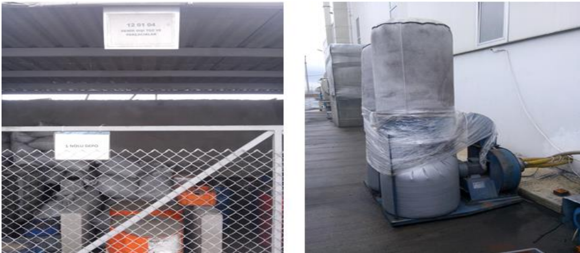
Şekil 4.7. Zımpara bölümündeki atıkların toz torbalarında biriktirilmesi ve geçici depolama alanındaki görüntüsü
