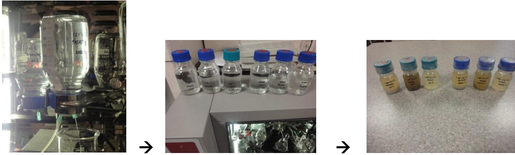
Şekil 4.13 70. saat sonundaki gaz toplama şişeleri ve mikroorganizmalı besi ortamları
