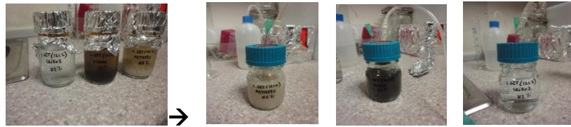
Şekil 4.10 121 °C’lik deney seti besi ortamlarından N 2 gazı geçirme yöntemi
