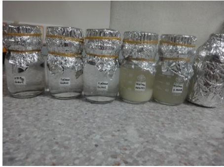
Şekil 5.1 Farklı besi ortamlarında hidrojen üretim sistemi
