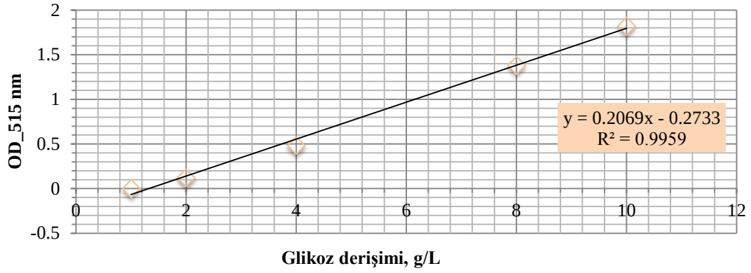
Şekil 6.3 Patatesin glikoz içeriği kalibrasyonu
