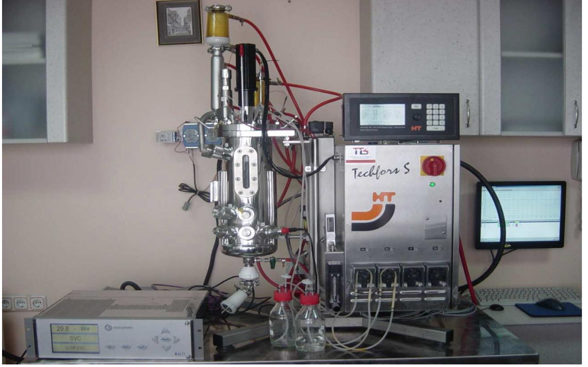
Şekil 4.20 Techfors S biyoreaktor deney düzeneği
