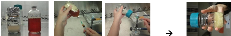
Şekil 4.6 Liver ortamından 400 g/L patates ortamına mikroorganizma aktarımı
