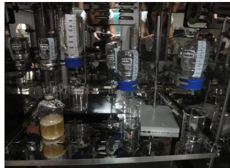
Şekil 5.1 Farklı besi ortamlarında hidrojen üretim sistemi
