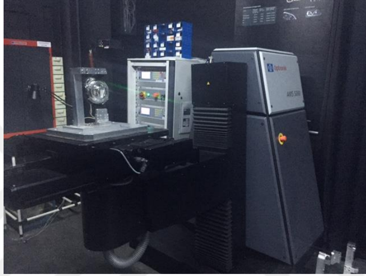
Şekil 3.47. AMS 5000 gonyometre ve fikstürle sabitlenmiş ürün
