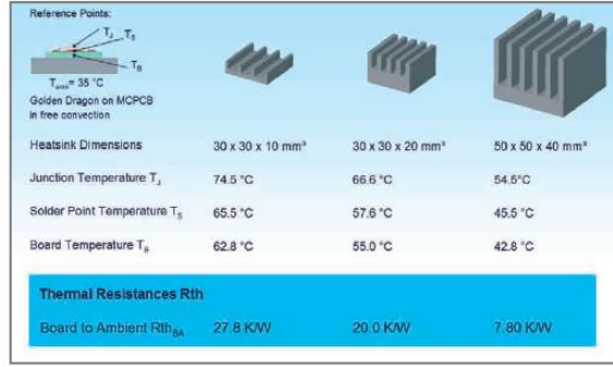
Şekil 2.8. Farklı kanatçık boylarına göre birleşim noktası sıcaklıklarının değişimi. Huber (2007)
