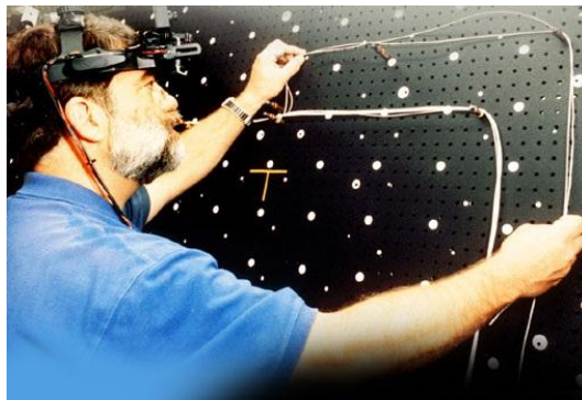
Şekil 1.7. Boeing'deki operatörler için geliştirilmiş AG sistemi [15]
