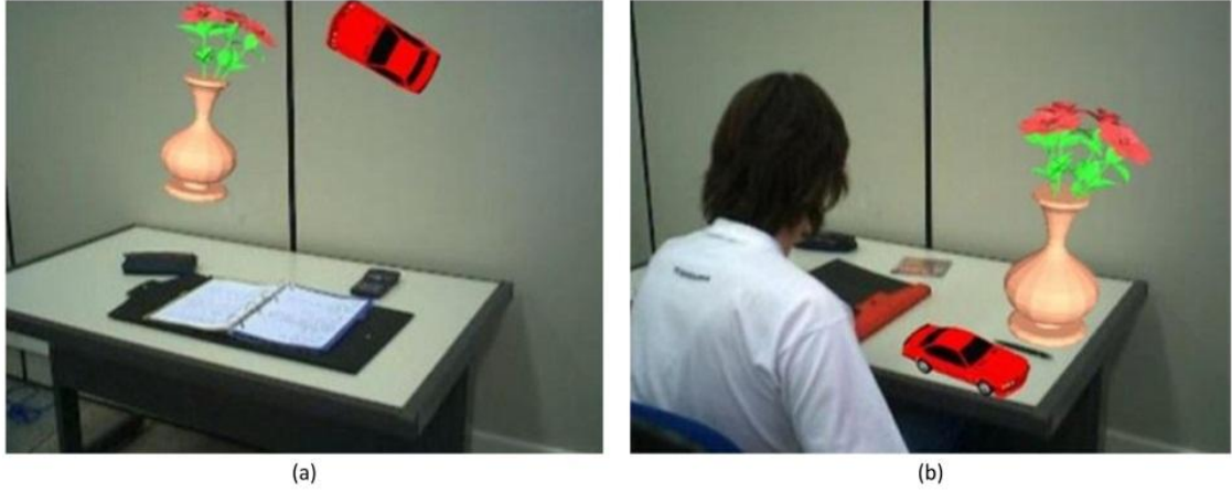
Şekil 1.74. Sanal vazo ve araba modelinin masa ile hatalı (solda) ve doğru (sağda) hizalanması [74]
