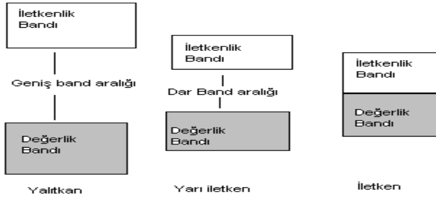
Şekil 1.3. Bant aralıkları bakımından üç iletkenlik sınıfının şematik olarak gösterimi
