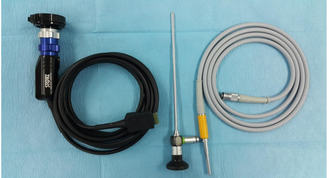
Şekil 3.4. Telecam SL kamera kafası, teleskop ve fiberoptik ışık kablusunun görüntüsü
