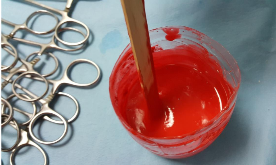
Şekil 3.18. P7670 A ve P7670 B maddelerinin eşit oranda karıştırılması sonrası kırmızı renk ile renklendirilmesi
