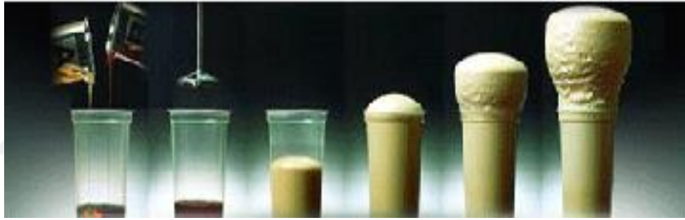
Şekil 2.9. Poliüretan köpüğün oluşum şekli
