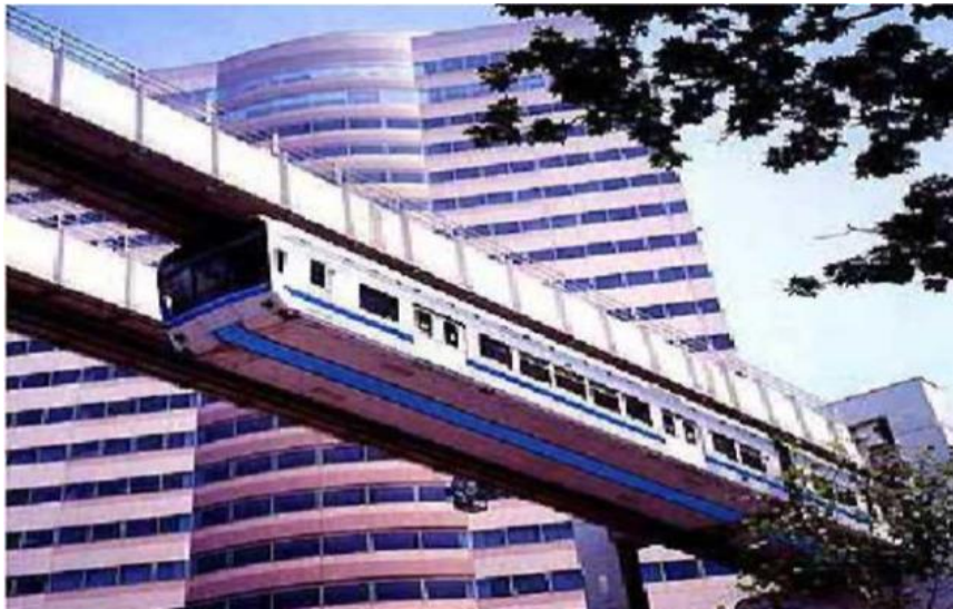
Şekil 3.2 : Askı tip monoray örneği, Japonya-Chiba (Kennedy, 2007).
