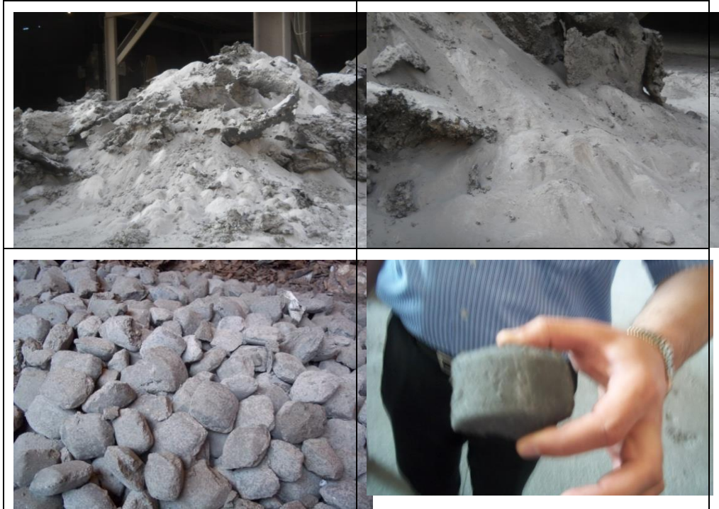
Şekil 5.3 İşlenmiş ve işlenmemiş pota fırını cürufklarına ait görüntüler
