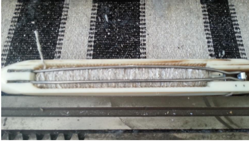
Resim 4.37. Mekikli dokuma tezgâhında kullanılan mekik ve masura (Üner, 2016)
