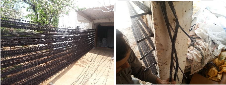
Resim 4.8. Çözgü çekme işlemi ve çapraza alma (Üner,2016)
