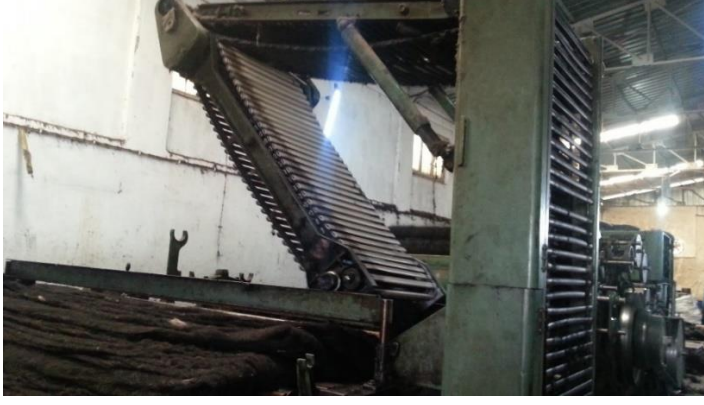
Resim 4.21. Ştrayhgarn tarağı ara besleme (Üner, 2016)
