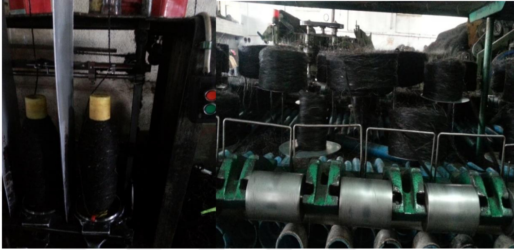
Resim 4.26. Kıl elyafı ring iplik eğirme işlemi ve baskı silindirleri (Üner, 2016)
