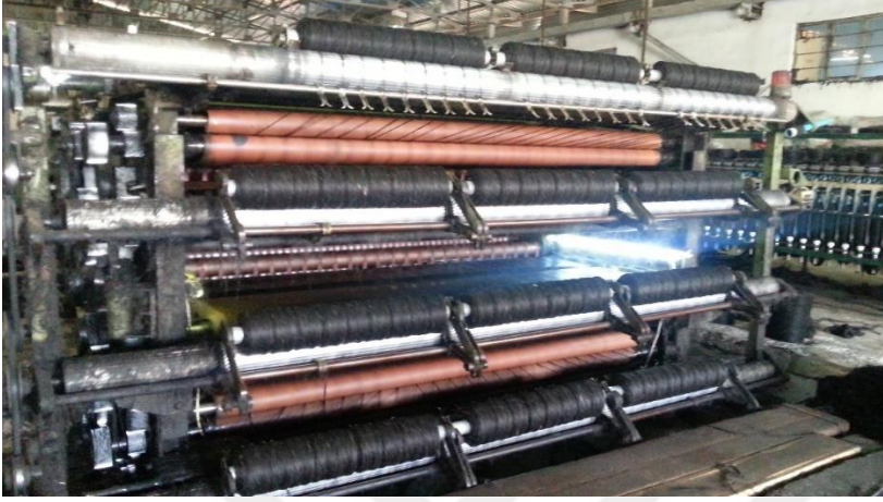
Resim 4.24. Ştrayhgarn tarağı önlük kısmı (Üner, 2016)
