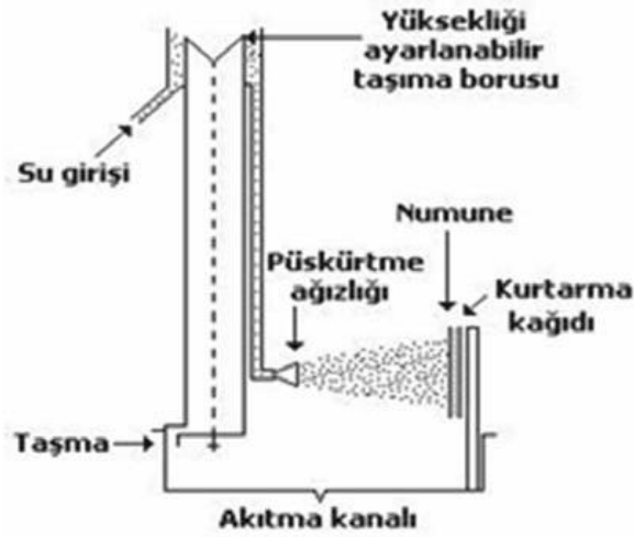
Resim 2.18. AATCC Yağmur testi düzeneği (Bulut ve Sölar, 2015)
