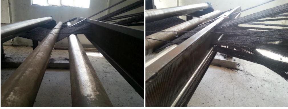
Resim 4.35. Tanzim tarağı ve gergi silindirleri (Üner, 2016)
