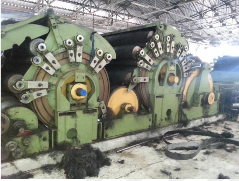
Resim 4.20. Ştrayhgarn tarağı tarak kısmı (Üner, 2016)
