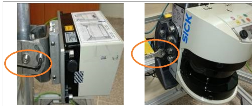
Şekil 3.18 Yol yüzeyine paralel yatay düzlemin yakalanabilmesi için anahtar yardımı ile cihazlara açı ayarı yapılması işlemi
