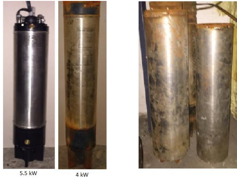
Şekil 3.5. Dalgıç pompa motorları ve motor kılıfları
