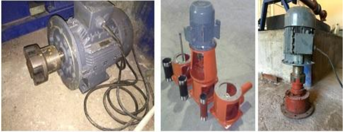
Şekil 3.6. Milli pompalara ait elektrik motoru ve tahrik grubu
