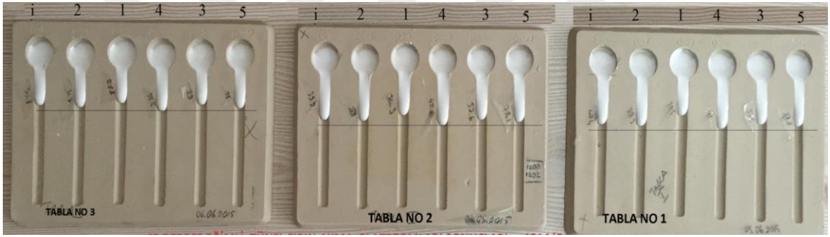
Şekil 7: 45° eğimli oluklu rampalar üzerinde ergimiş sır akma boylarının görünümü.
