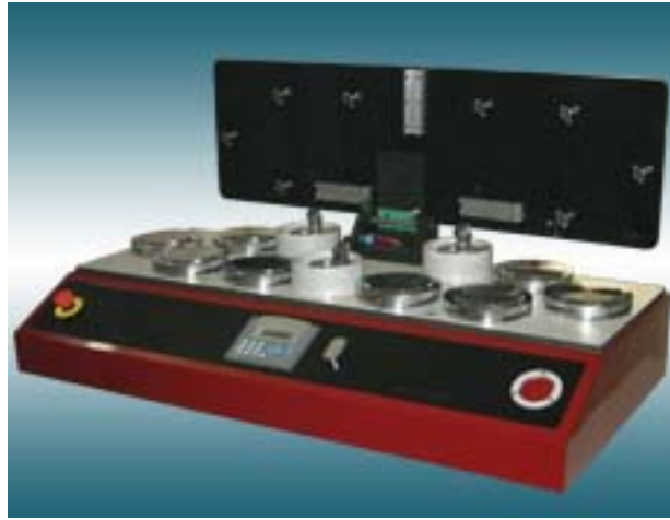
Şekil 2.5. Aşındırma ve boncuklanma test cihazı (Martindale) [49]
