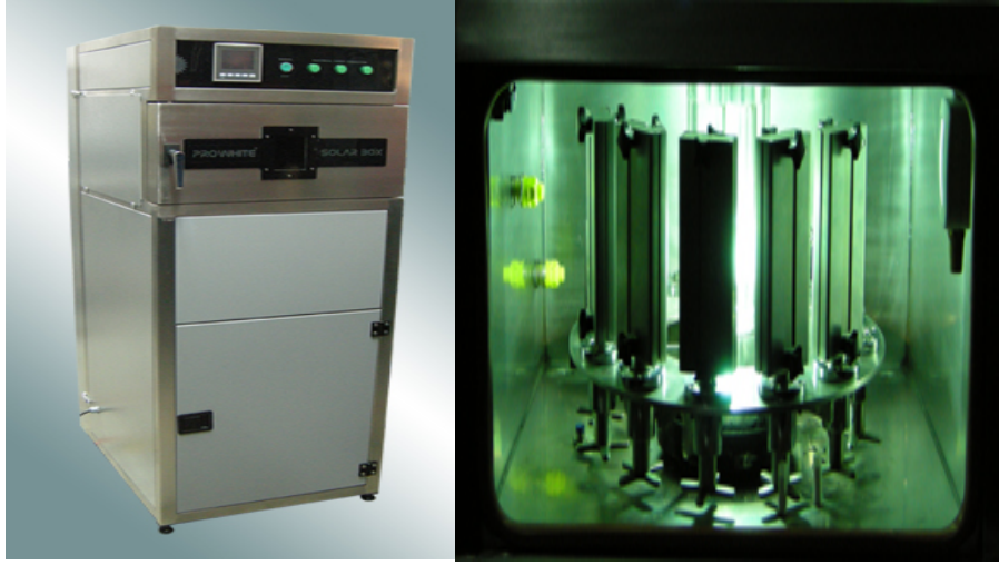
Şekil 2.4. Işık haslığı test cihazı [48]
