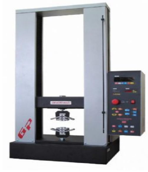
Şekil 2.3. Çekme-basma test cihazı (Devotrans) (kopma-yırtılma mukavemeti için) [47]
