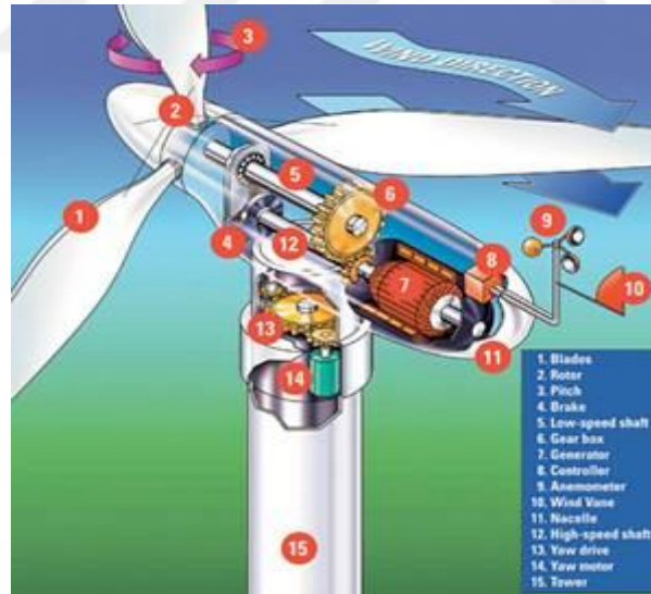
Şekil 5.5. Bir rüzgâr türbininin elemanları
