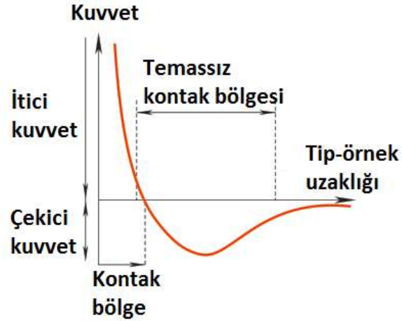
Şekil 1.13. AFM’de farklı kuvvet bölgelerinde, tip-örnek etkileşimi (NT-MDT Integrated Solutions for Nanotechnology, 2016)
