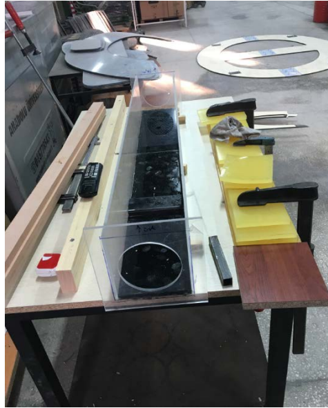
Görsel 4.10. Optik Hava Tünel Montajı
