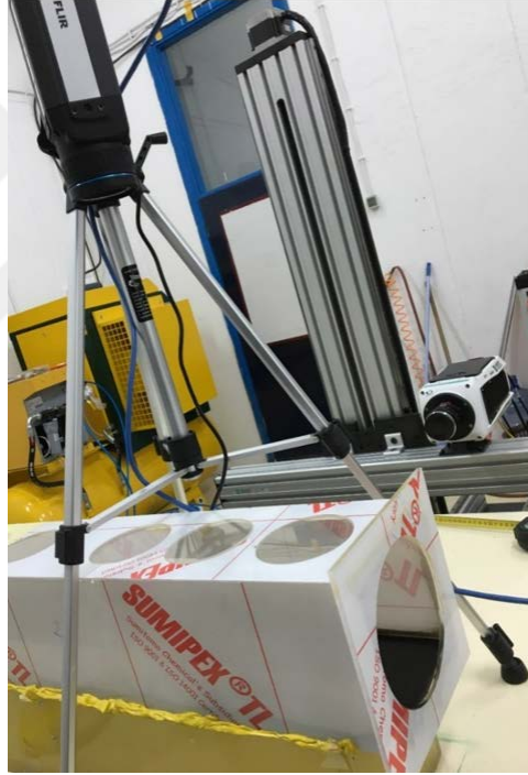
Görsel 4.18. IR Kamera ve Termal Test Düzeneği
