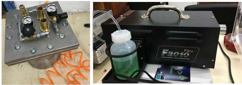
Görsel 4.14. Sıvı Parçacık Jeneratörü ve Duman Jeneratörü
