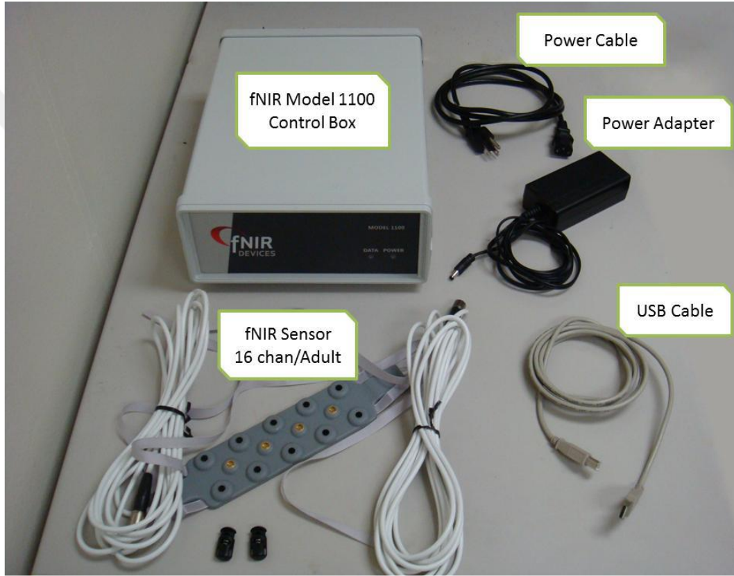
Şekil 3: fNIRS sensörü. Tez çalışmasında kullanılan fNIRS cihazının 16 kanal, 4 LED ve 10 dedektörden oluşan sensörü gösterilmektedir. (Cognitive Optical Brain Imaging (COBI) Studio fNIR Devices LLC. Copyright © 2013)
