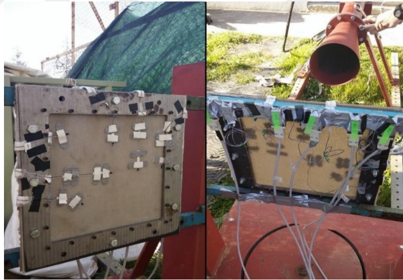
Şekil 4.30 : Basınç sensörleri(solda) ve RS232 bağlantıları(sağda).
