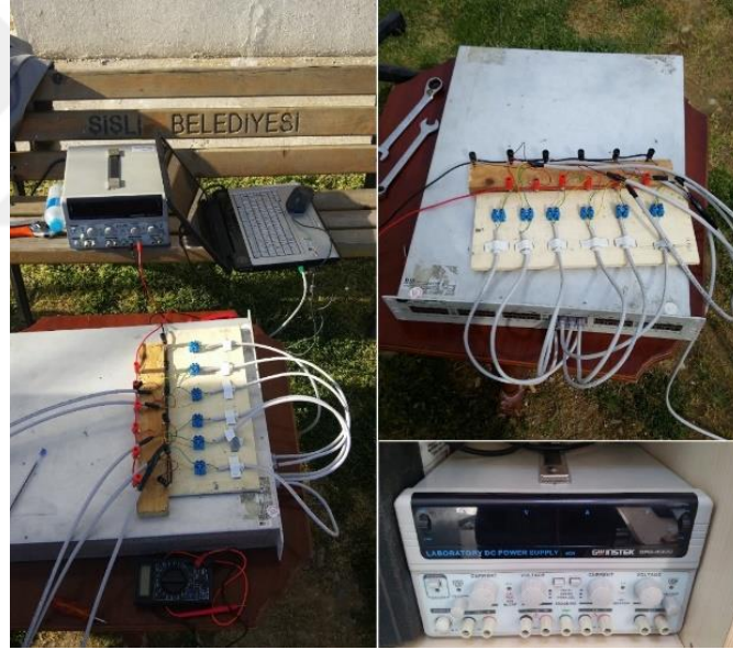
Şekil 4.9 : Güç kaynağı-RJ45 bağlantıları (solda ve sağ üstte) ve GPS4303 regülatör(sağ altta).
