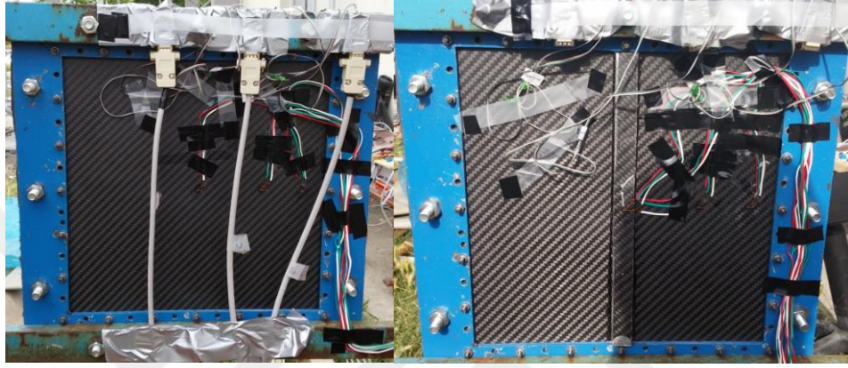
Şekil 4.13 : Takviyesiz plağın (solda) ve tek takviye elemanlı plağın (sağda) deney sırasında arkadan görünüşü.
