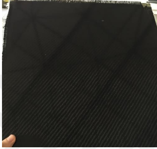
Şekil 2.3 : Karbon elyaftan üretilen plak.
